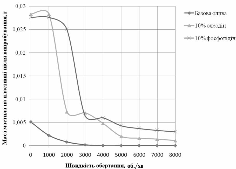
Залежність залишкової маси базової оліви І-20А та 10%-ових розчинів у ній олеодіну і фосфолідину на сталевій пластині від швидкості обертання робочого диска
