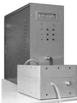
Рис. 2. Прототип электрохимического реактора синтеза растворов гипохлорита натрия с внешним модулем насоса, оснащенный системой контроля и управления технологическими параметрами на базе микроконтроллера PIC16F876A
