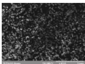
Рис. 1. Мікрофотографія кремній-вуглецевого наповнювача, одержаного із рисового лушпиння (збільшення в 40 разів)
